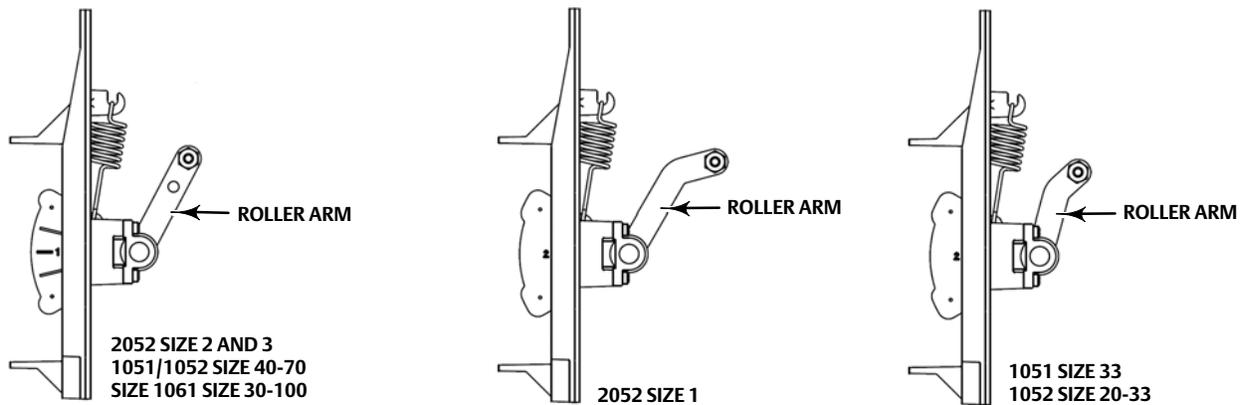
NOTE THE DIFFERENCE IN THE SHAPE AND LENGTH OF THE ROLLER ARM
