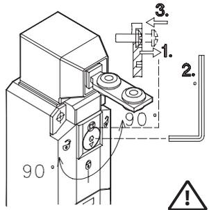
1. Sicherungsschraube lösen
